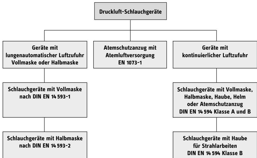
Bild 23: Einteilung der Schlauchgeräte
