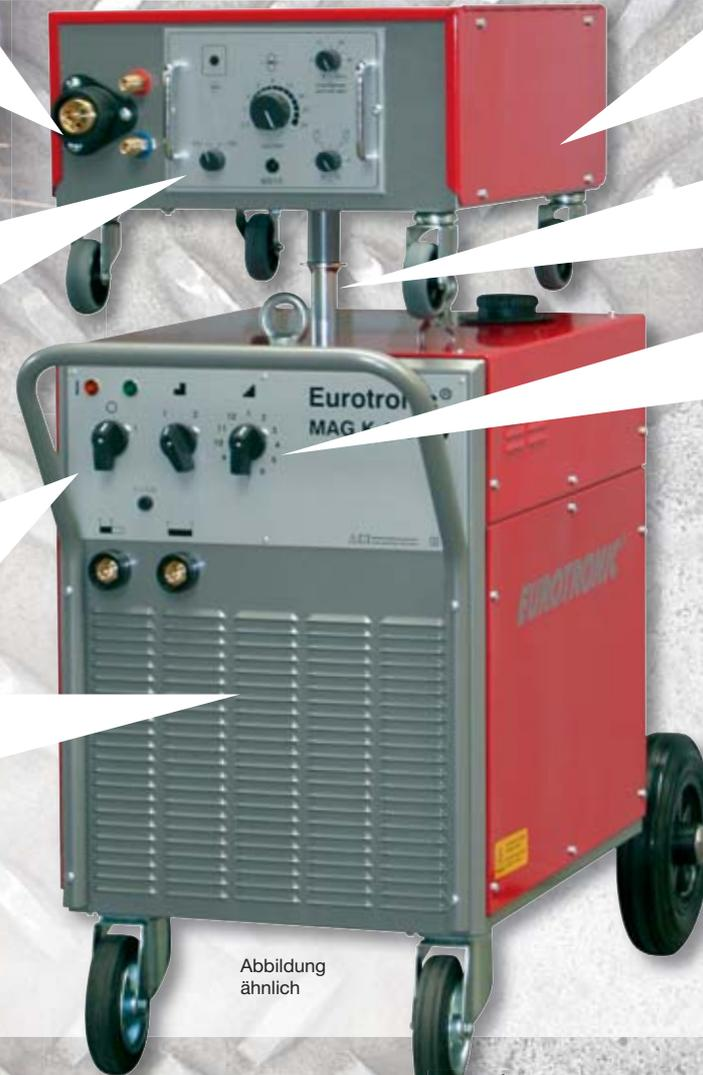
EURO-Zentralanschluss; für Drahtdurchmesser 0,8 bis 1,6 mm
