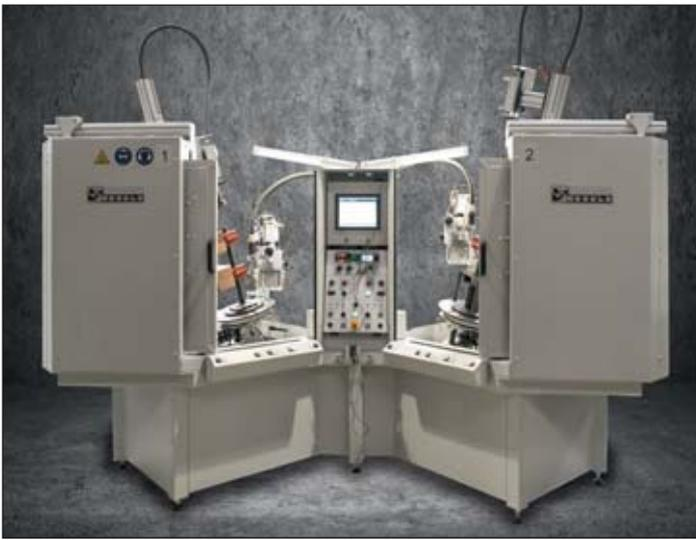
Doppel-Rundnaht-Schweißautomat mit zwei Drehtischen und zentraler Steuerung.
