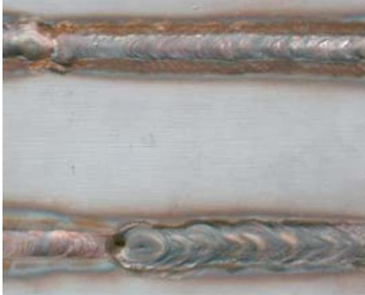
Korrosion an einer nicht behandelten Edelstahl Schweißnaht
