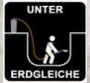
Grundsätzlich sollte man sich beim Arbeiten mit Propangas Folgendes vor Augen führen: **Propan ist schwerer als Luft!** Es besteht daher in Räumen, die nicht durchlüftet werden können (z. B. Kellerräume, Gruben, Tanks), ein besonderes Explosionsrisiko, da sich Propangas in solchen Räumen am Boden sammelt und somit ein zündfähiges Gas/Luft-Gemisch entstehen kann.
