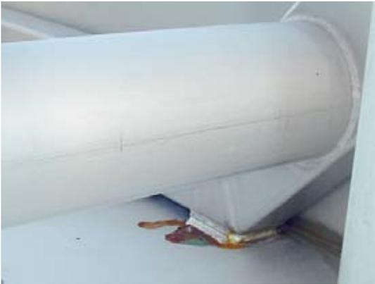
Auslaufen von Beizrückständen an nicht dicht geschweißten Röhren
