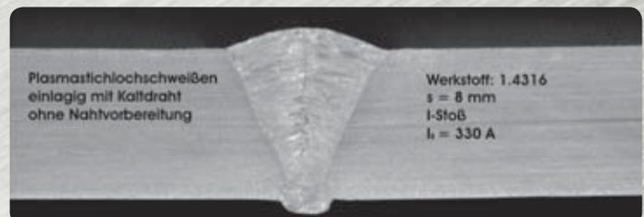
Der harte Plasma-Lichtbogen, der zum Schweißen dickerer Bleche mit der „Stichlochtechnik“ verwendet wird, entsteht durch die Wahl einer höheren Plasmagasmenge.
