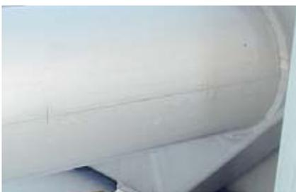
Auslaufen von Beizrückständen an nicht dicht geschweißten Rohren
