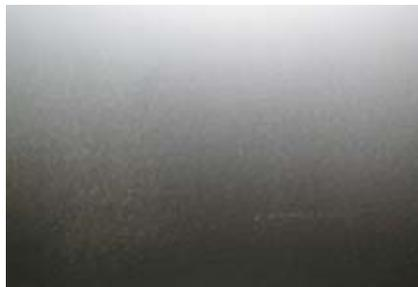
Sogenanntes Leopardenmuster durch zu große Sprühdüsen-Bohrung
