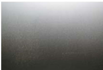
Sogenanntes Leopardenmuster durch zu große Sprühdüsen-Bohrung
