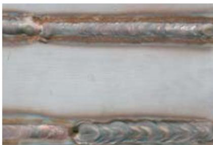
Korrosion an einer nicht behandelten Edelstahl Schweißnaht
